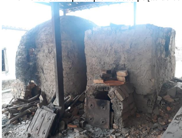
Foto 7 – Forno de barro para queima das peças de cerâmicas
