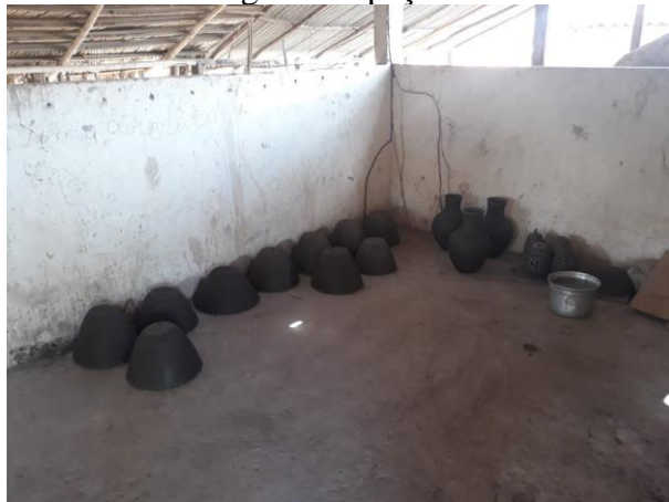
Foto 7 – Secagem das peças de cerâmicas
